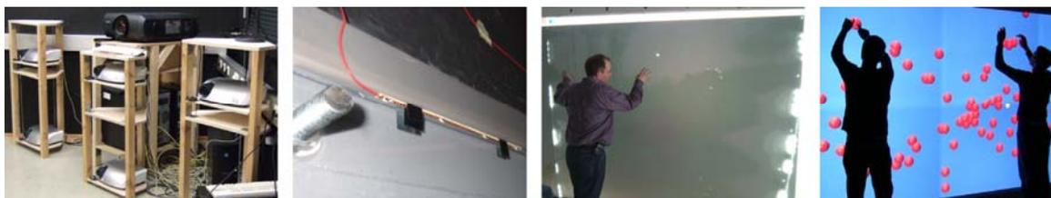
**Abb. 7: Die FTIR-Technologie ermöglicht das Tracking von Berührungen der HeyeWall (Bild 3,4), indem Infrarot-Leuchtdioden (Bild 2) seitlich in die Scheibe einstrahlen.**
