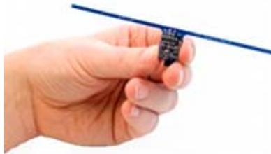
**Abb 4: Kontaktloser RFID-Sensor WISP**
