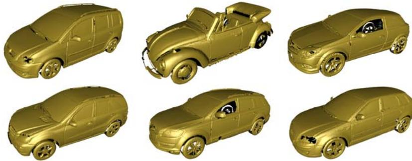
**Abb. 1:** Hochqualitative Flächen (class-A) findet man vor allem im Automobilbau. 3D-Scans von Spielzeugmodellen bieten eine erste Basis, um die Varianz im Flächendesign zu erforschen.
