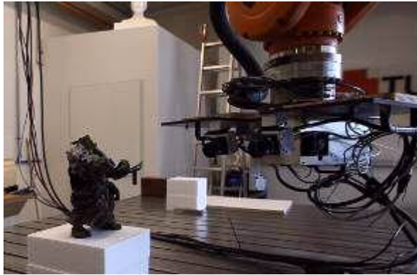
Abb. 7.2.6: 3D-Rekonstruktion einer Spielzeugfigur, welche von den Studierenden im Rahmen zweier Seminar-Projekte durchgeführt wurde. Dazu wurde das Kamera-System auf einem Industrieroboter montiert und um das Objekt bewegt.
