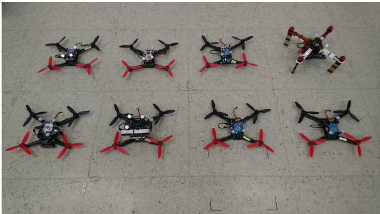
Abb. 7.1.1: Die neuen Drohnen des droneSpace. 8 der 10 Drohnen wurden bereits fertiggestellt und sind in Verwendung. Die Drohnen sind je nach Aufgabe mit unterschiedlichem Kamerasystem ausgestattet. Es gibt zwei Bauformen, eine für Innenraum-Flüge und eine größere Bauform, die auch für den Außenbereich geeignet ist. Alle Drohnen besitzen leistungsfähige Onboard-Computer für Echtzeitbildverarbeitung. Alle Drohnen können über ROS (Robot Operating System) drahtlos angebunden werden.
