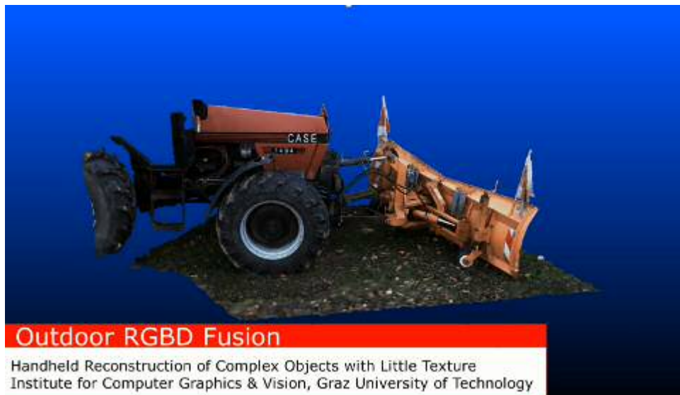
Abb. 7.2.5: Outdoor-3D Rekonstruktion eines Fahrzeuges. Ein Fahrzeug mit schwierigen Oberflächeneigenschaften wie untexturierter Oberfläche, dunklen/hellen Bereichen, glänzenden Oberflächen und feinen Details, wurde mit dem Handheld-System digitalisiert.
