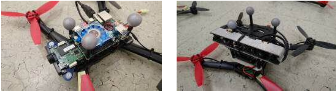
Abb. 7.1.2: (links) Eine Drohne ausgestattet mit dem Qualcomm Sensorpaket. Die Drohne besitzt Kameras nach unten und vorne sowie einen Qualcomm-Spezialprozessor für Flugsteuerung und Bildverarbeitung. (rechts): Eine Drohne ausgestattet mit einer Tiefenkamera für Echtzeit-3D Scanning.
